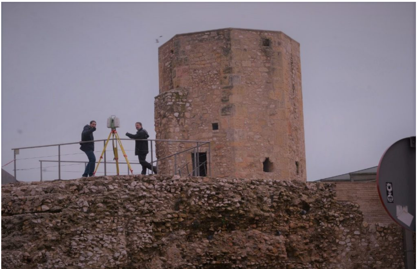
Ivan Fernández i Josep Maria Puche (ICAC) durant les tasques d'escaneig del conjunt arquitectònic del Circ de Tarragona. Foto: ICAC.
