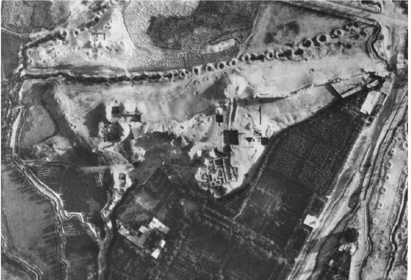
Figura 1: La línia de pous de qanat prop de Chashmal-i Ali, a prop de Teheran (Iran) (segons Schmidt 1940, pl. 37a; Buławka, Orengo i Berganzo-Besga 2024, Fig. 1).
