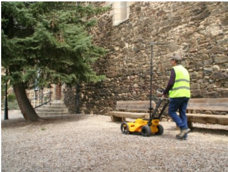
Prospecció amb georadar a la sagrera de l'església de Llivia.
