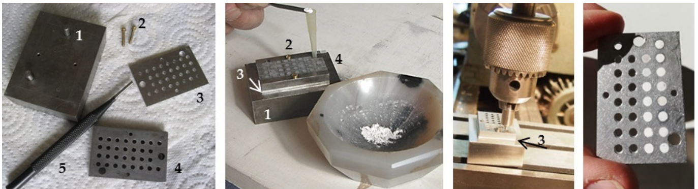
Secuencia de la preparación de muestras para el análisis CL-cuantitativo, desarrollada por Ph. Blanc en la UPMC de París (© Ph. Blanc)
