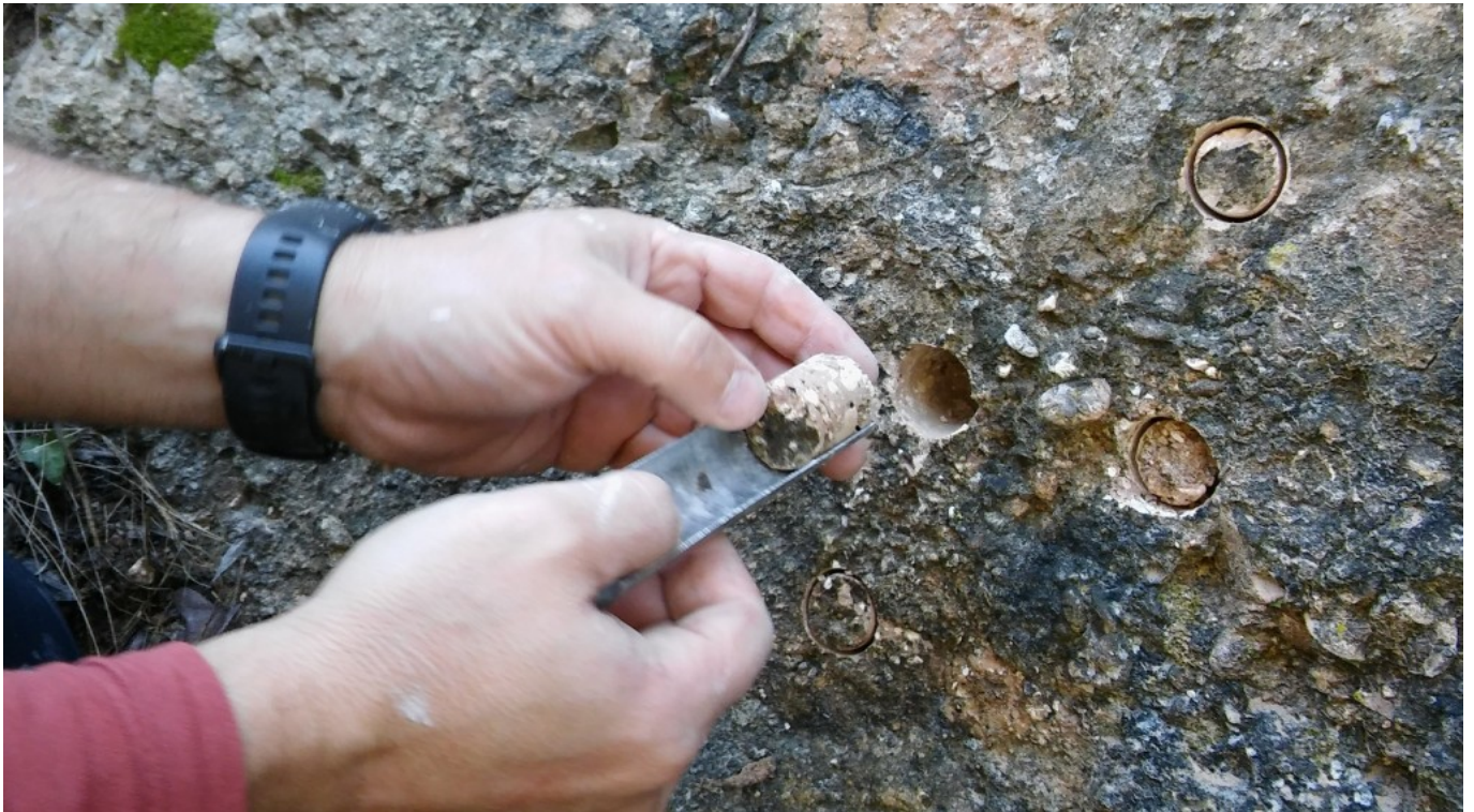
Extracción de la muestra para la datación por arqueomagnetismo. En la foto, Lluís Casas (UAB). Foto: ICAC.
