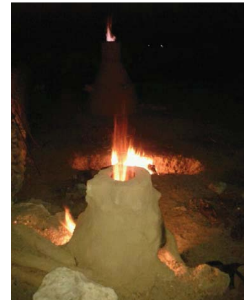
Forn experimental de reducció de ferro realitzat a la Ciutadella Ibèrica de Calafell
